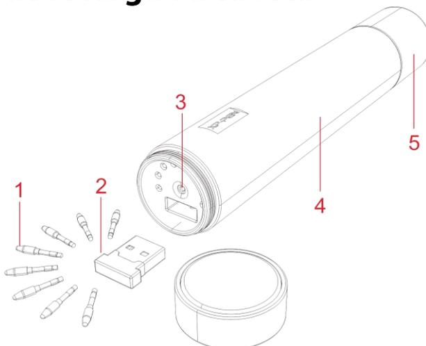
Imagem 2-2: Recarga de caneta, Receptor de USB, Trocador de recarga da caneta, Tampa de caneta & Suporte da caneta
