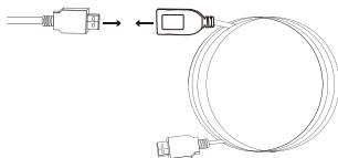
Imagen 3-1: método de conexão de cabo de transmissão
