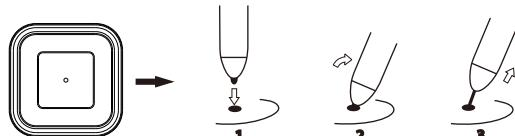
Imagen 2-2: como substituir a recarga
